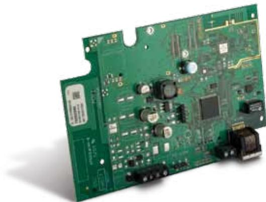
**Comunicación de alarma totalmente redundante hacia la estación de monitoreo**
